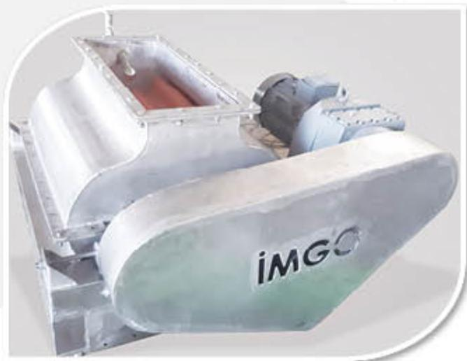
Cekirdekli meyvelerin değirmene ve ısıtıcıya verilmeden önce meye içerisinde bulunan çekirdeklerin gıda uygun kauçuk ve metal dişli ile sıkıştırılması sayesinde çekirdekler kırılmadan meyveden ayrılarak çekirdek, çekirdek fırçalamaya meye parçaları ise değirmene gönderilmesini sağlamaktadır. Makine AISI 304-316 Kalite paslanmaz çelikten imalatı yapılmaktadır. Meyve patlatma ünitesinin farklı özelliklerde, ölçülerde ve kapasitelerde imalatı yapılmaktadır.
