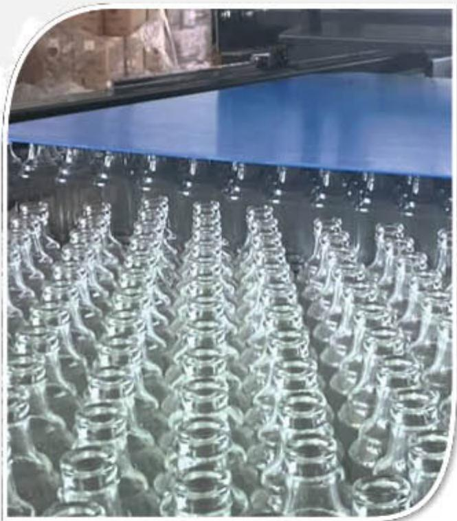
Makina gövdesi St malzemeden üretilmektedir. Makinenin tüm hareketleri PLC ile kontrol edilecektir. Palet bozma makinesinin farklı özelliklerde, ölçülerde ve kapasitelerde imalatı yapılmaktadır.
