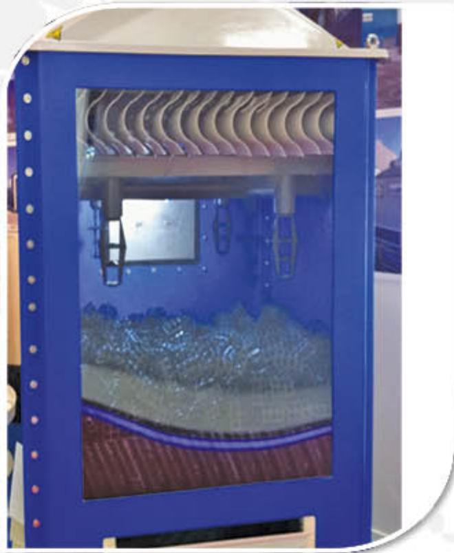
Soğutma kuleleri Mika ve PVC malzemelerden imal edilmektedir. Vantilatörler aksiyel veya radyal fanlar kullanılmakta üretim alaşlarının pozisyonlarına göre evaparasyon sistemleri, dolum tesisleri ve pastörizasyon ünitelerinde sıkılıkla kullanılan sistemlerdir.
