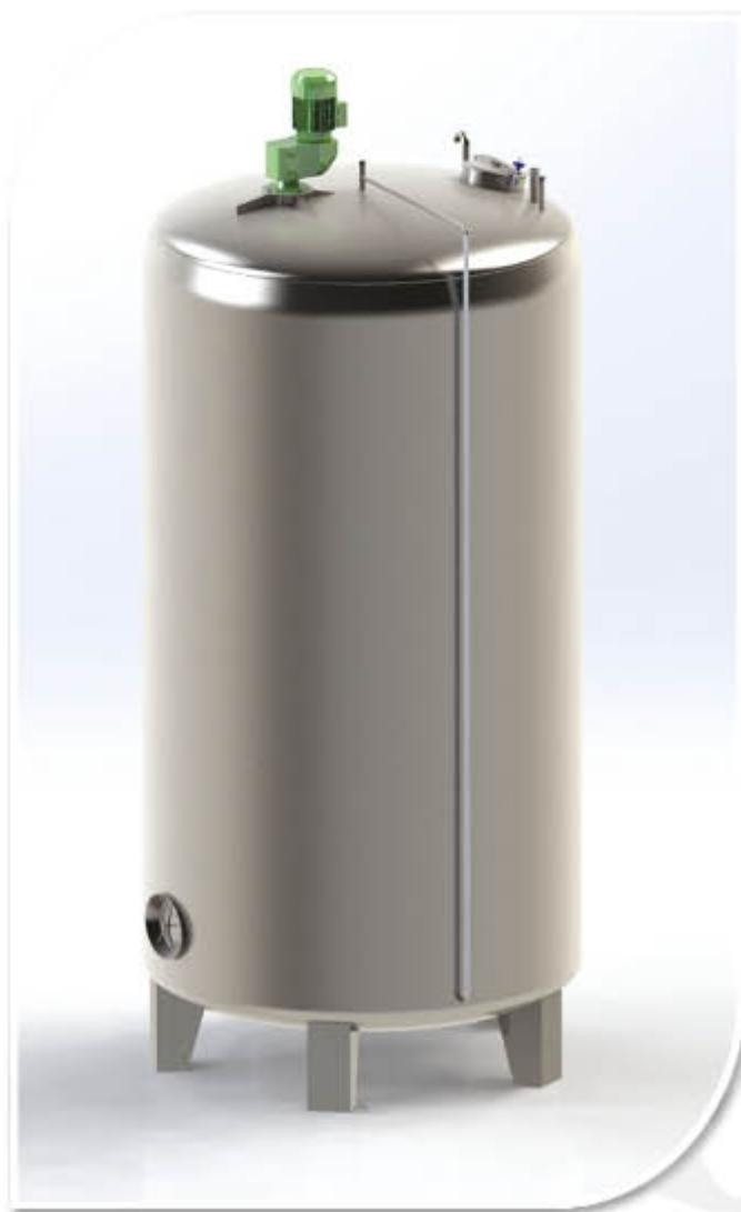
Meyve suyu besleme tankları, enzimasyon ve durultma hazırlamada kullanılan gıda normlarına uygun hijyenik imal edilen tanklardır. İsteğe bağlı olarak AISI 304 ve AISI 316 kalite paslanmaz çelikten imalatı yapılmaktadır. Tanklar üzerinde türbülans karıştırıcı sistemi, PVC ürün seviye göstergesi, numune vanası, C.I.P döner başlıklı top, menhol kapağı, havalandırma başlığı ve ürün giriş çıkış rekor takımları bulunmaktadır.
