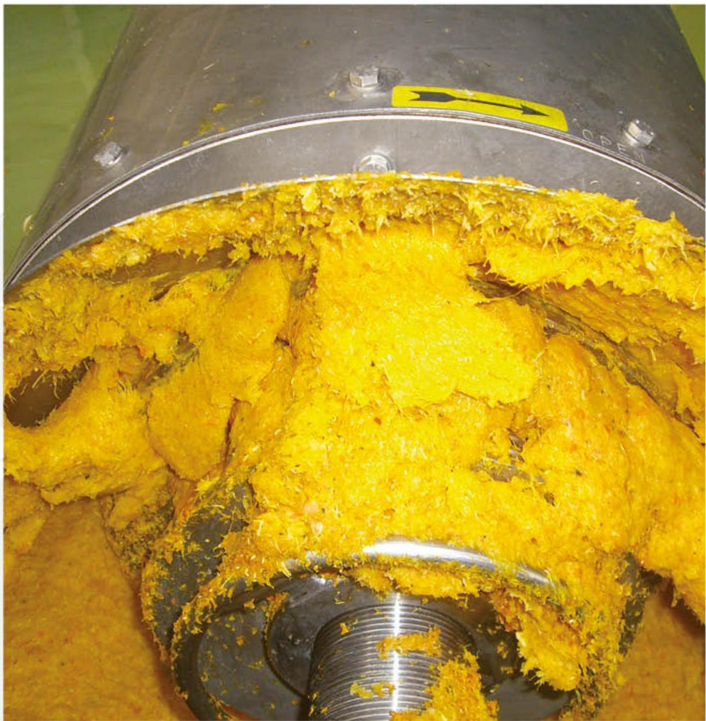
Palper filtre ürüne temas eden yüzeyler AISI 304 paslanmaz çelik, makine şasisi ST 37 boyalı malzemeden imal edilmektedir. Ürün sayklon filtreden sonra iki aşamalı filtre edilmektedir. İlk aşama 0,4 mm gözenekli ikinci aşama 0,3 mm delik çapında eleklerden basınç sayesinde öğütülen ürün fan ve elek arası mesafe ayarı ile istenilen randıman ve kalitede ürüne ayarlama olanağı vardır. Palper makinesi farklı özelliklerde, ölçülerde ve kapasitelerde imalatı yapılmaktadır.
