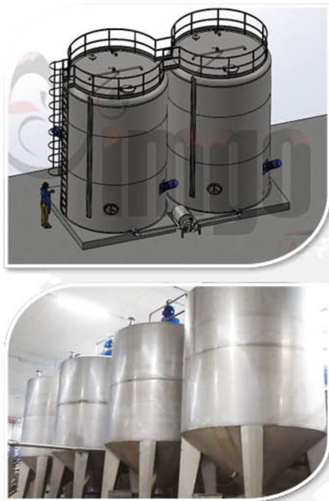
Beç tankları dolum öncesi ürün hazırlamada kullanılan gıda normlarına uygun hijyenik imal edilen tanklardır. İsteğe bağlı olarak A.304 ve A.316 kalite paslanmaz çelikten imalatı yapılmaktadır. Tanklar üzerinde türbülans karıştırıcı sistemi, ürün seviye göstergesi, numune vanası, C.I.P döner başlıklı top, menhol kapağı, havalandırma başlığı ve ürün giriş çıkış rekor takımları bulunmaktadır. Tank taban noktası huni şeklinde olup pürelî ürünlerin akışına göre dizayn edilmektedir.
