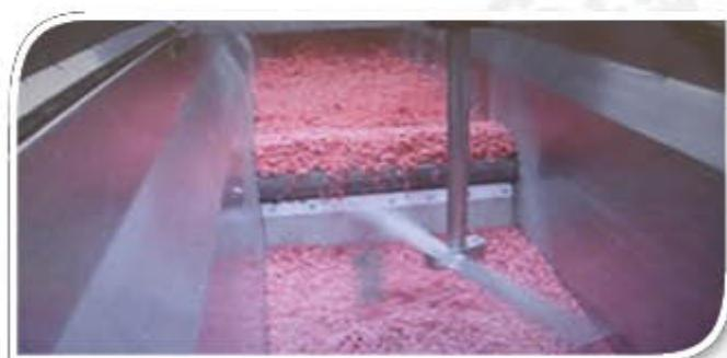
Bireysel hızlı dondurma (IQF) doğranmış veya dilimlenmiş elmaların düşük sıcaklıklarda (-30 ile -40°C arasında) hava püskürtmeli akışkan yataklı dondurucuda dondurulması işlemi olup, konvansiyonel dondurmaya kıyasla çok daha kısa sürede gerçekleştirilmektedir. Dondurma işlemi sırasında hava güçlü fanlar yardımıyla gıda maddesi ile evaporatör arasında hızla hareket eder ve böylece durgun hava ile yapılan dondurma işlemine kıyasla gıda maddesinin daha kısa sürede dondurulması sağlanır.
