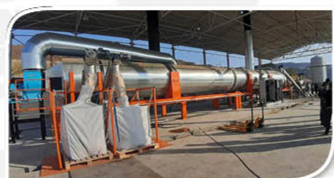
Kurutma makinesi çekirdeklerin kurutulması için dizayn edilmiştir.
